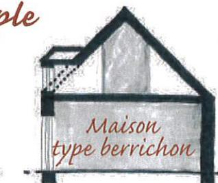
Pour la même profondeur de maison, un comble simple sous toiture à faible pente reste inaccessible alors que le comble sous toiture à forte pente offre plus d'espace sous faitage et est souvent accompagné d'une porte fenièrre servant d'accès.
