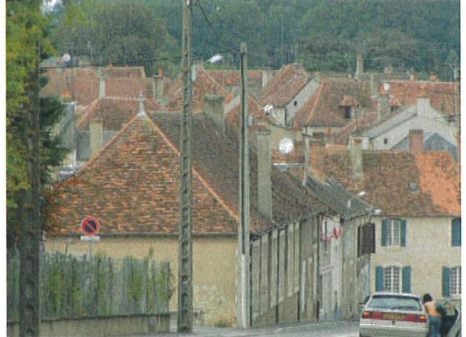
*Les toitures à pentes fortes (entre 40 et 45°), couvertes de tuiles plates ou d'ardoises, à l'est de la Gartempe.*
