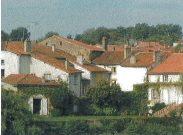
*Les toitures à pentes faibles (entre 19 et 24°) couvertes de tuiles canal, à l'ouest de la Gartempe.*
